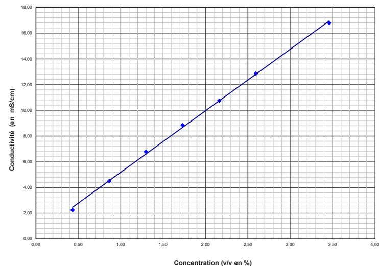
La mesure de la conductivité, pour certains produits, est sensible à la dureté de l'eau. Bien vérifier votre dureté, et celle utilisée pour la courbe. La mesure de la conductivité se fait à 25°C et a été réalisée avec le conductimètre WTW 3110.
